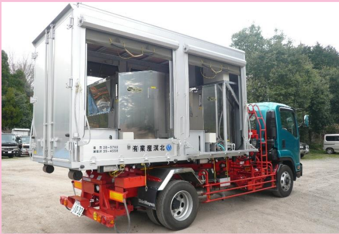
生ごみ液化プラントコンテナを備えた車両 (新明和工業㈱と共同発明)
